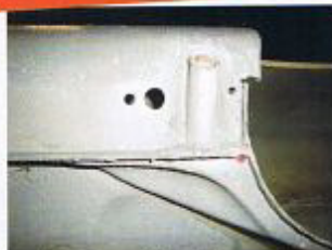
Delikatesse: perfekte Wagenheberaufnahme und Achsblech von unten
