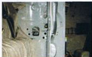
Oft Ort des 18-Schreckens: der Lüftungswasserkasten in seiner gesamten Breite
