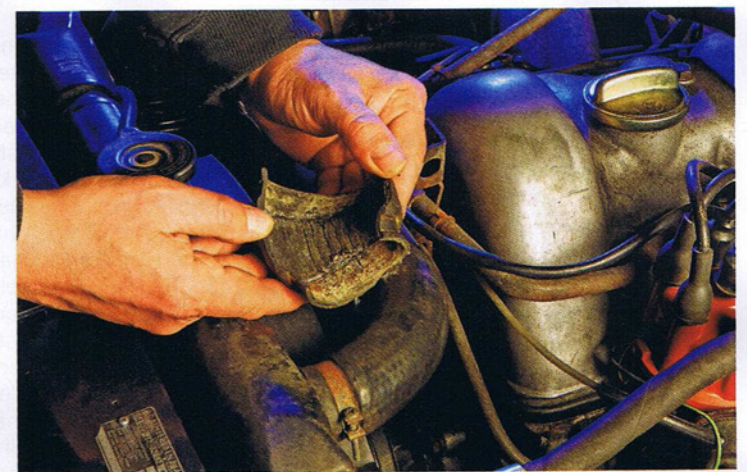
GEFAHR VON INNEN Auch wenn die Kühlwasserschläuche auf den ersten Blick noch gut aussehen: Schaut man ins Innere, zeigen sich Kalkablagerungen und gefährliche Risse. Unter Druck können die Schläuche undicht werden
