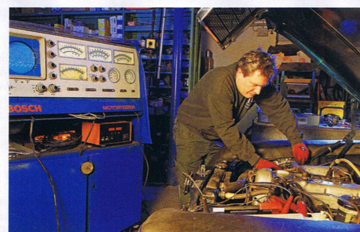
AUFS RICHTIGE WERKZEUG KOMMT ES AN Mit einem Motortester lassen sich zahlreiche Funktionen und Systeme prüfen. Für einen Check der bei manchen Strich 8 verbauten D-Jetronic bedarf es einer zusätzlichen speziellen Ausrüstung
